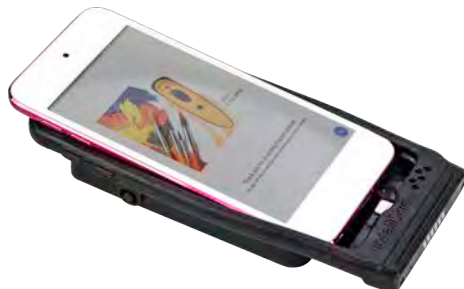
Schritt 4: Mobilgerät in das DuraCase schieben
