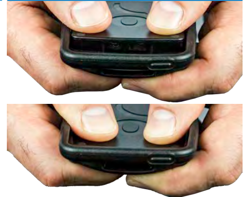
Schritt 6: Mobilgerät einrasten
